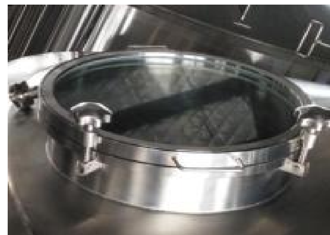
Top glass manhole
